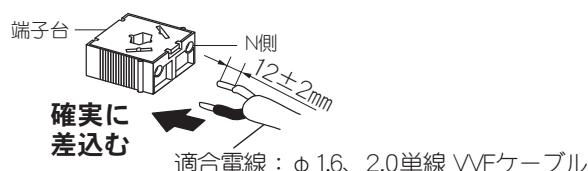
注) 電源線接続後、余分な電源線は必ず電源穴へ押込むこと。
