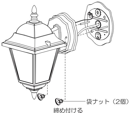
袋ナット（2個）を工具で確実に締め付けてください
