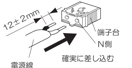
器具の取り替えなどで電源線を外す場合は、解除穴(2カ所)マイナスドライバーなどを解除穴に差し込みながら電源線を引き抜く。
