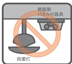
・樹脂製パネル付器具を間接照射式殺菌灯と近接配置するとパネルが劣化します。殺菌線が当たらないよう設置してください。
