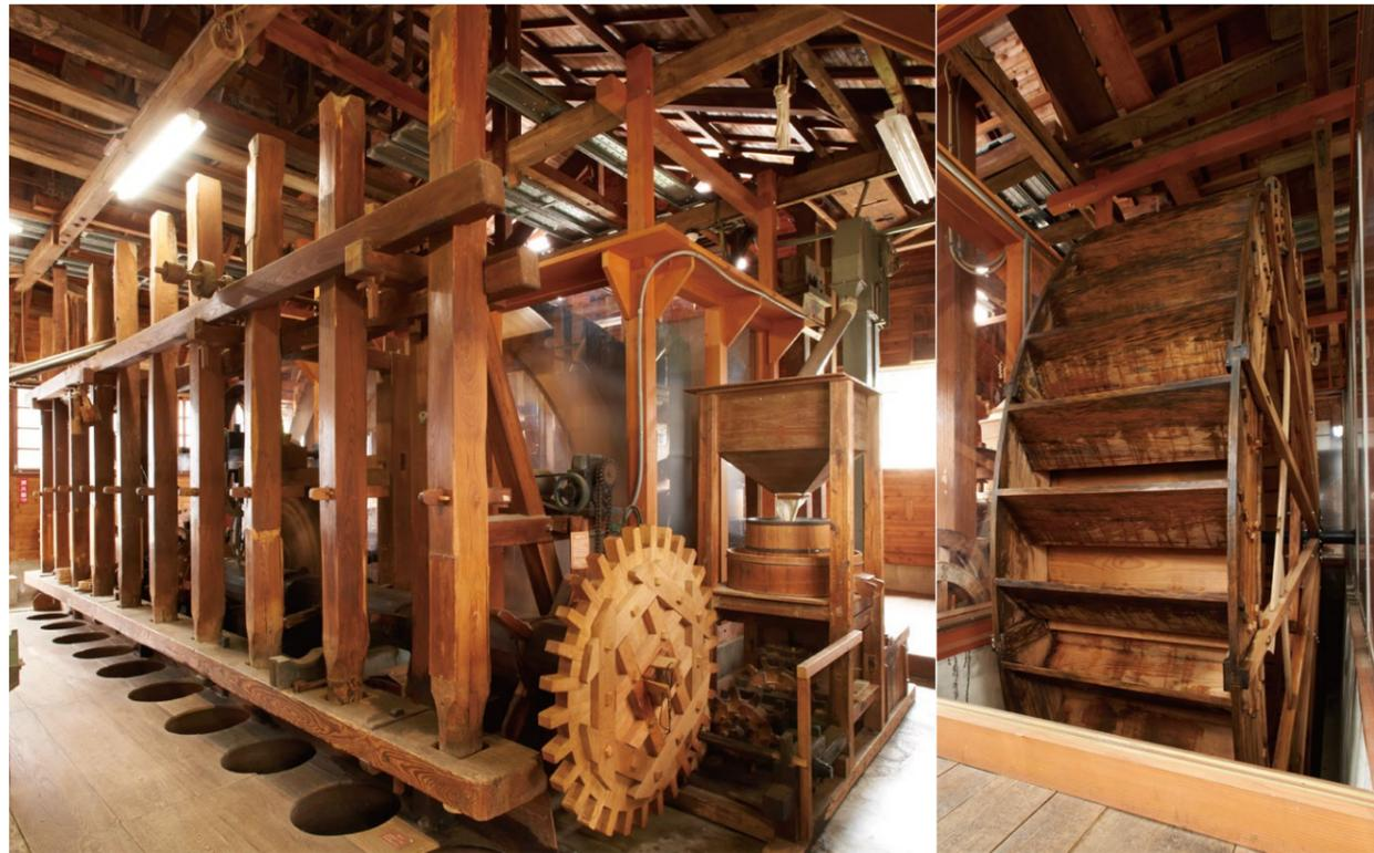
水輪の両側に杵や臼、ふるいを備え、水でつくったエネルギーを多様な仕事に変換する。作業時、直径4.6mの水輪(右)は毎分10~12回転した
