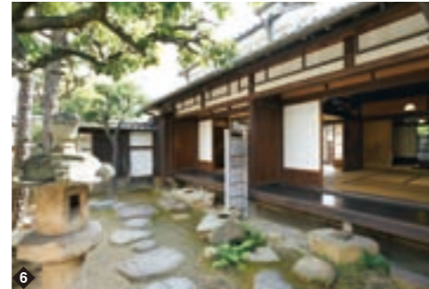
6 町屋には玄関を作らないのが当時のしきたりであったため、坪庭には美しさだけでなく、明かり取り、通気といった役割がある
