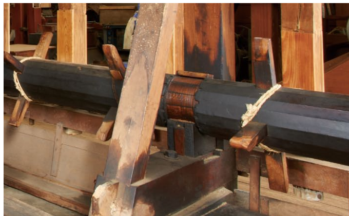
回転し、なで棒で杵を持ち上げる横心。屋敷林のケヤキを用いることもあった。高価な木材なので、摩耗の激しい部分だけを交換できるように工夫し、日頃は家人が修理した
