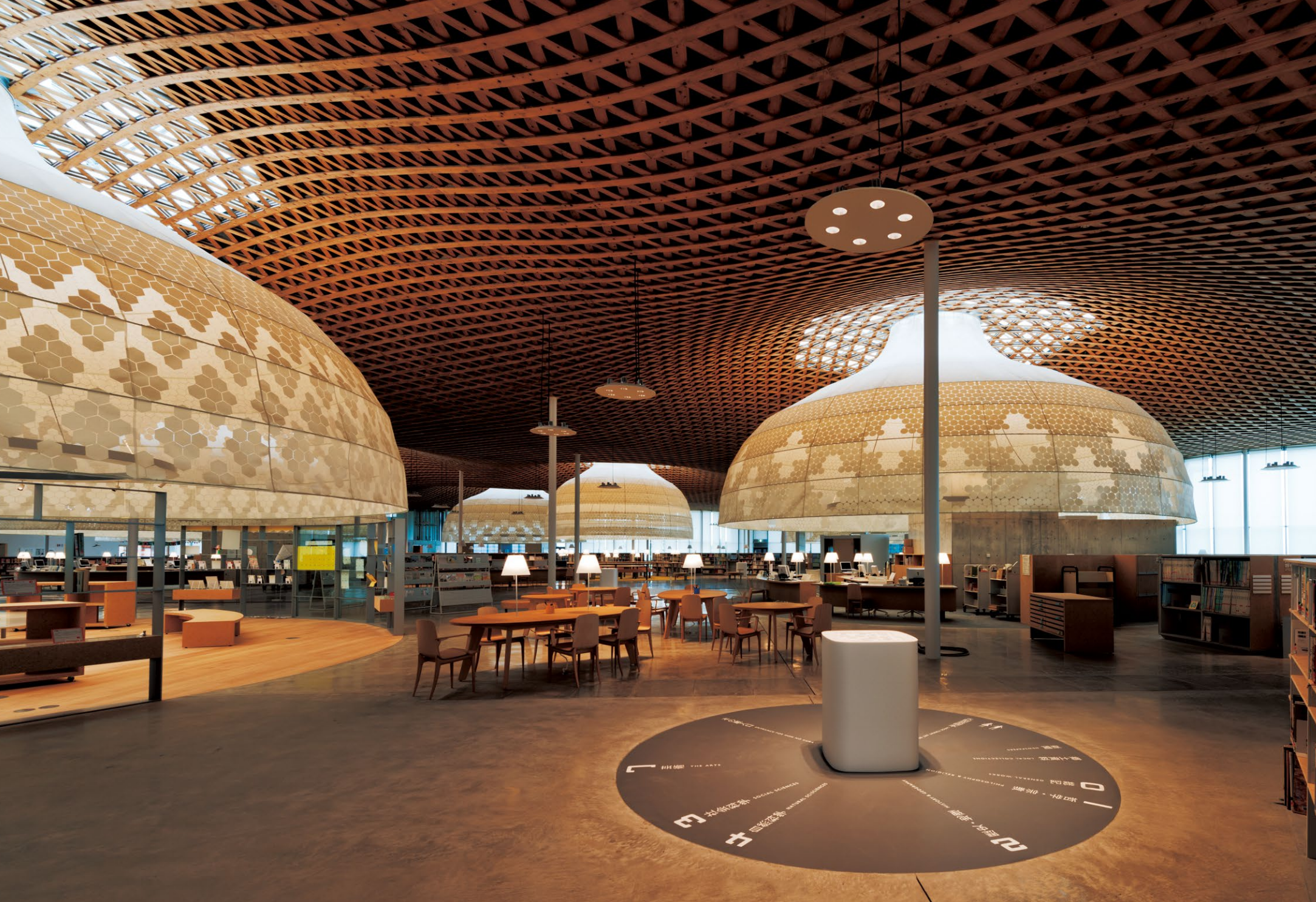
人が集う場所だけをグローブで覆うことにより効率よく空調を行い、自然光を拡散しながら取り込み、内部を柔らかな光で満たしている
