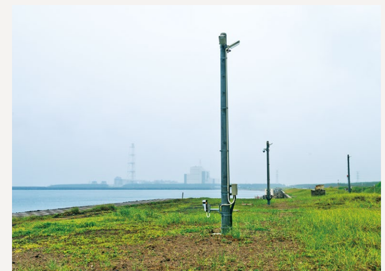
沿岸部を監視するレーザーセンサとドーム型監視カメラ。ドームカメラには親水コーティングが施されている
