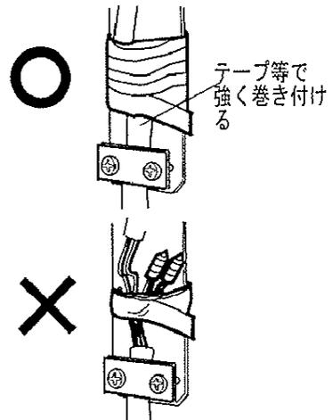
圧着スリーブ等で結線後、テーピングで十分に絶縁処理したのち線のかみ込み防止のため、余った線を結線金具にテープ等で固定してください。
