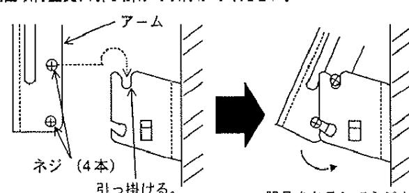
器具をおろしてネジを十分締め付けてください。
