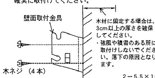
②本体アーム側のネジ穴にネジを4箇所仮止めし、壁面取付金具に引っ掛けて取付けてください。
