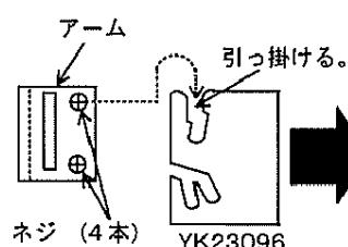
23° 11° の角度に器具をおろしてネジを十分締め付けてください。
