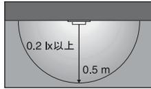
停電後に約 30 分まで、床面で約 0.2 lx以上の明るさが直径 1 mの範囲で得られます。
