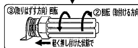
③取りはずす場合には、軽く押し付けながら取付けと逆の方向に回転させてください。
