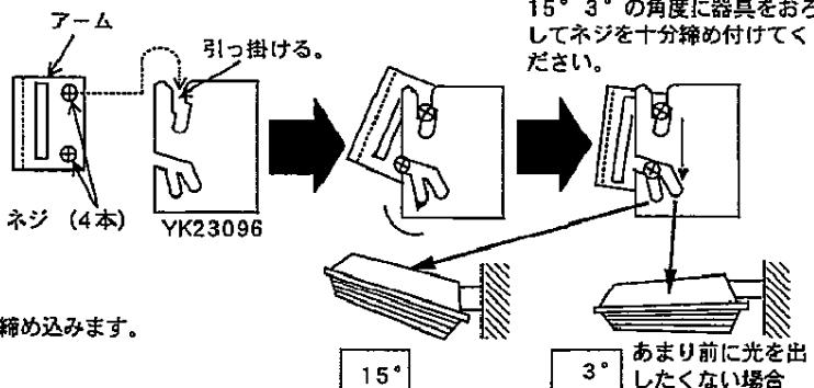
15° 3° の角度に器具をおろしてネジを十分締め付けてください。
