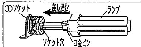
②軽く押し付けた状態でランプを少し回転させて取付ける。(回転角度約15°)
