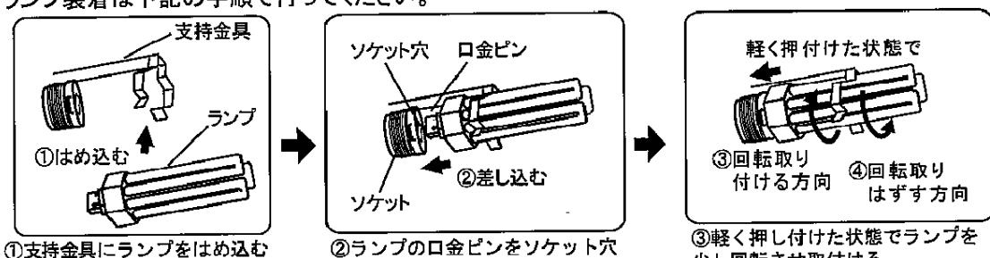
④取りはずす場合には、軽く押し付けながら取付と逆方向に回転させてください。
