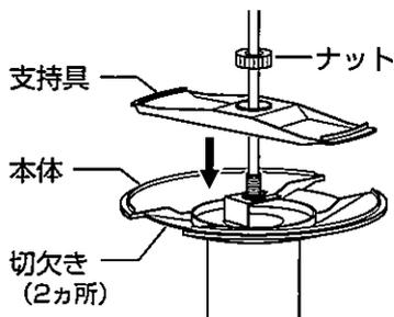
② 本体の切欠き(2カ所)にカバー開口部を沿わせながら、カバーを取り付ける。
