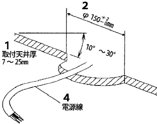
2. 天井に $\phi 150_{-0}^{+2}$  mmの埋込穴をあける
