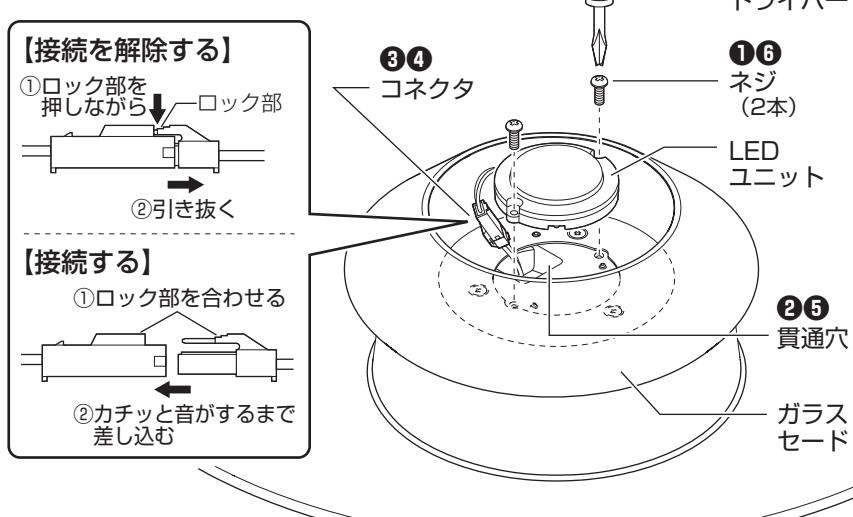
手順①で器具側コネクタが貫通穴に入り込んでしまい、貫通穴から引き出せない場合は、上カバーを持ち上げて、コネクタを貫通穴から押し出してください。
