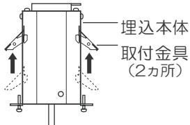
②取付金具を押さえながら埋込本体を埋込穴に挿入する
