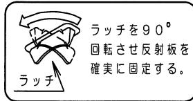
ラッチを90°回転させ反射板を確実に固定する。
