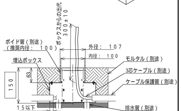
器具が地表から出ないようにボックス設置面が水平で平滑になるように仕上げ及び高さ調整する。
