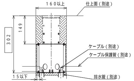
器具が地表から出ないように、ボックス設置面が水平で平滑になるように仕上げ及び高さ調整してください。
