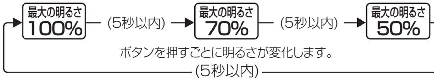
「明るさ調整」設定後(5秒後に)、設定した最大の明るさでエコナビがスタートします。
