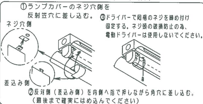
指定以外のランプ使用を防止するため必ずランプカバーを取付けてください。
