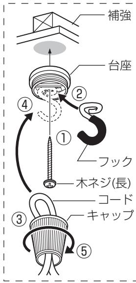
③キャップにコードを通してコードの長さを調整する
