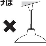
配線器具から直接器具を吊り下げる
