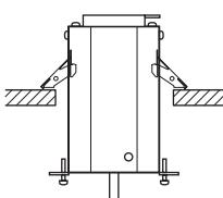
④取付金具を引き下げ、埋込本体を固定する
