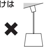
配線器具から直接器具を吊り下げる
