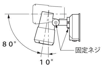
照射方向を調整したあとは、必ず固定ネジを増し締めする
