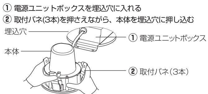
●石こうボードに取り付けた器具を取り外す場合は、枠部をゆっくり引き下げて取付バネ(3本)を押し曲げながら取り外してください。
