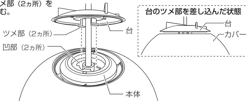
② 電源コードを持ち本体を持ち上げた状態で台を少し左に回して下におろし、本体にはめ込む。
