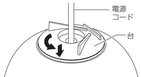
③ 電源コードを持ち本体を持ち上げた状態でナットを右に回して締め付ける。
