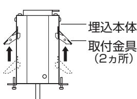
②取付金具を押さえながら埋込本体を埋込穴に挿入する
