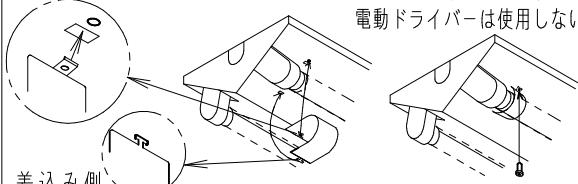
②反対側（差込み側）を内側へ指で押しながら角穴に差し込む。
