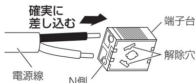
器具の取り替え等で電源線を外す場合は、マイナスドライバー等を解除穴に差し込みながら電源線を引き抜く。
