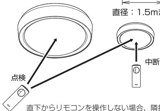
直下からリモコンを操作しない場合、隣接する器具も受信してしまうことがあります。その際は隣接する器具の直下から、リモコンの「中断」スイッチを押して点検を中断してください。
