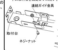
②連結ガイド金具の角穴に引掛ける。 ③付属のネジで固定する。 **9** 3
