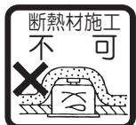
器具は、断熱材・防音材・造営材などと下図のような空間を設けて施工してください。
