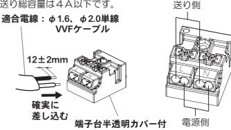
器具の取り替えなどで電源線を 外す場合はマイナスドライバー などで解除ボタンを押しながら 電源線を引き抜く。
