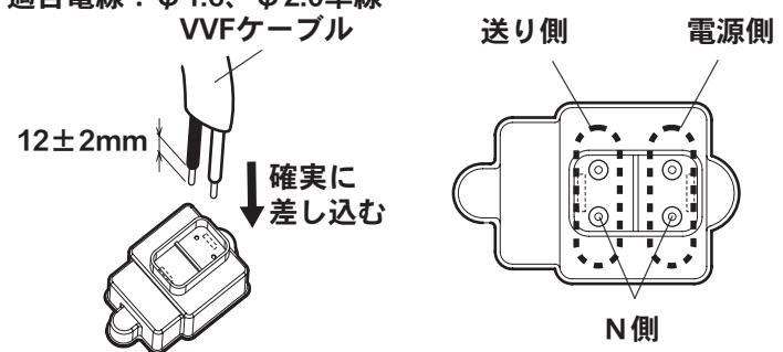
器具の取り替えなどで電源線を外す場合はマイナスドライバーなどで解除ボタンを押しながら電源線を引き抜く。
