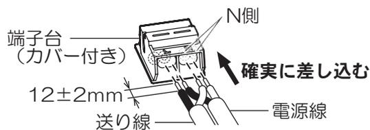
電源線の取り外し方は、マイナスドライバーなどで解除ボタンを押しながら電源線を引き抜く。
