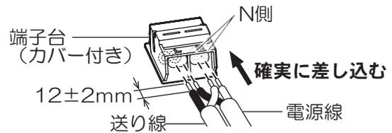
電源線の取り外し方は、マイナスドライバーなどで解除ボタンを押しながら電源線を引き抜く。
