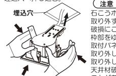
石こうボードから器具を 取り外す場合は、天井材の 破損にご注意ください。 枠部をゆっくり引き下げ、 取付バネを押し曲げながら 取り外してください。 取り外しに不備があると、 天井材破損の原因となる ことがあります。
