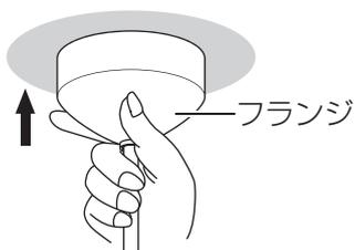
器具の高さを調節する場合は、コードの長さを調節してください (☞ 下記手順 **6** 参照)
