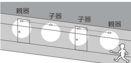
2台のセンサ付き器具(親器)の間にセンサなし器具(子器)を接続。どちらかのセンサ付き器具(親器)が点灯すれば、全ての器具が連動して点灯します。
