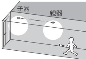
センサ付き器具(親器)とセンサなし器具(子器)を接続。センサ付き器具(親器)が点灯するとセンサなし器具(子器)が連動して点灯します。
