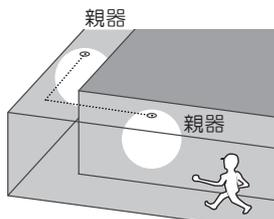
センサ付き器具(親器)同士を接続。どちらかのセンサ付き器具(親器)が点灯すれば、もう一方のセンサ付き器具(親器)も連動して点灯します。
