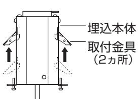
②取付金具を押さえながら埋込本体を埋込穴に挿入する
