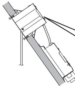
傾斜天井（55度以下）に取り付ける場合、取付方向指定表示の矢印が上側になるように取り付ける。
