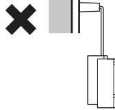
◎この器具は配線ダクト水平天井吊り下げ専用です。
