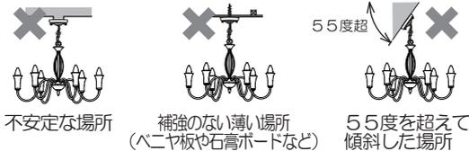
不安定な場所 補強のない薄い場所 (ベニヤ板や石膏ボードなど) 55度を超過して傾斜した場所
