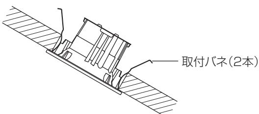
●石こうボードに取り付けた器具を取り外す場合は、枠部をゆっくり引き下げて取付バネ(2本)を押し曲げながら取り外してください。取り外しに不備があると、天井材破損の原因となることがあります。
