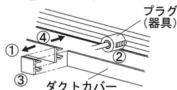
**確認** ●取り付け後ストッパーを下げずに回し、外れないことを確認してください。
