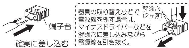
③余分な電源線は電源穴に確実に押し込む。
